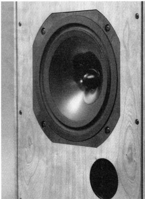
ウーファーはHLコンパクト7ES-2と同じ「RADIAL」コーンを採用した200mm口径。ポリプロピレンに混入するアルミニウムの配合量を、中心から周辺にかけて変えたダイアフラムは、高精度射出成型機で作ることで優れた物性を確保している
