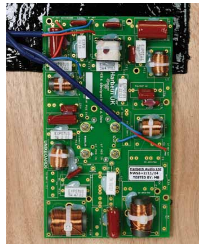
Die verschraubte Schallwand ist gar nicht, die Rückwand nur leicht gedämpft, dafür gibt es viel Schaumstoff. Die auf die Rückwand geschraubte Weiche ist hochwertig und reichhaltig bestückt (unten).
